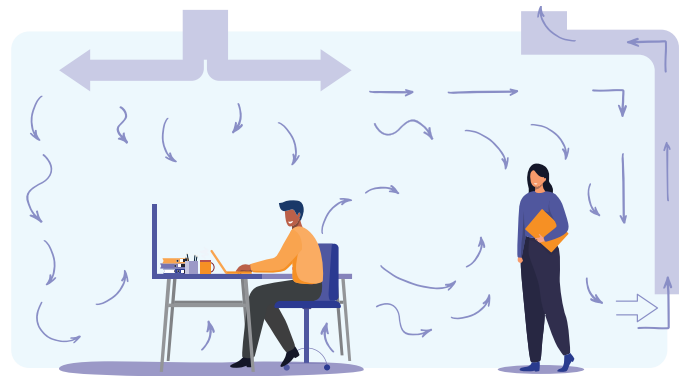
Ventilatie met luchttoevoer in het plafond, luchtafvoer onderin de ruimte
